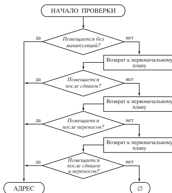
Рис. 2. Блок-схема процедуры определения возможности внесения действия в план
